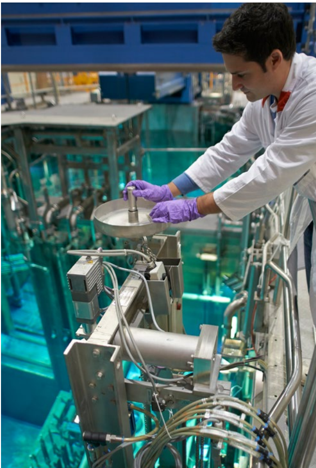
In der Kapselbestrahlungsanlage wird Kobalt-60 hergestellt.
