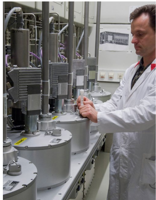
Die Proben werden mit einer Rohrpost zur Bestrahlung in das Reaktorbecken gesandt.
