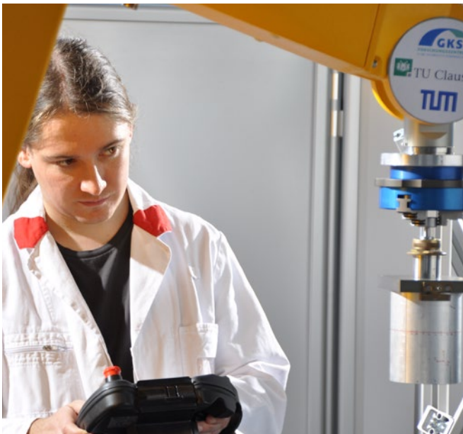
Mit einem Roboter werden die Proben am Instrument STRESS-SPEC gehandhabt.
