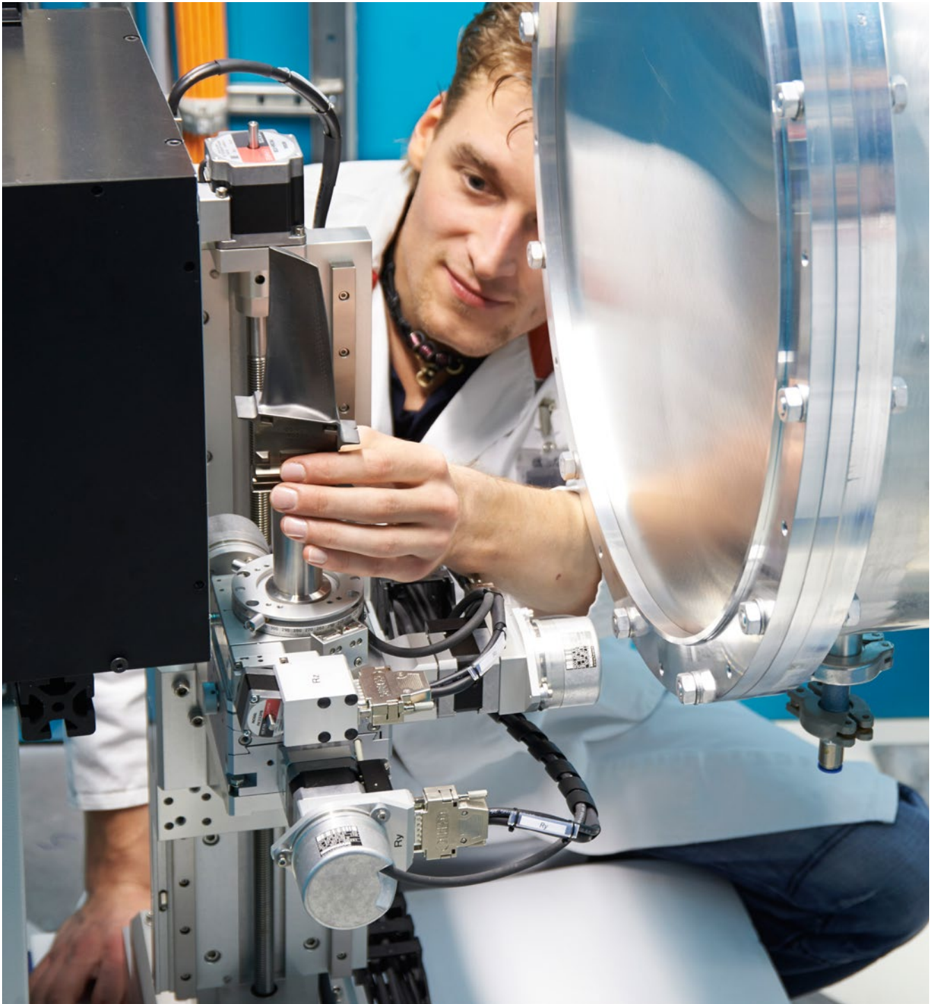
Radiographien von großen Bauteilen sind am Instrument ANTARES möglich.
