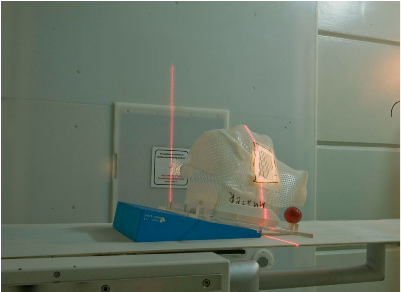
Die Tumorbestrahlungsanlage am FRM II mit der Gesichtsmaske für eine genaue Positionierung des Patienten.
