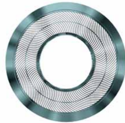
Querschnitt durch das Brennelement des FRM II.
