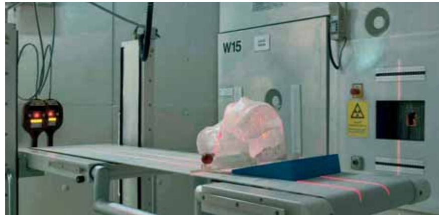
Bestrahlungsraum für schnelle Neutronen am FRM II: Auf der Liege kann der Patient optimal im Neutronenstrahl positioniert werden.
