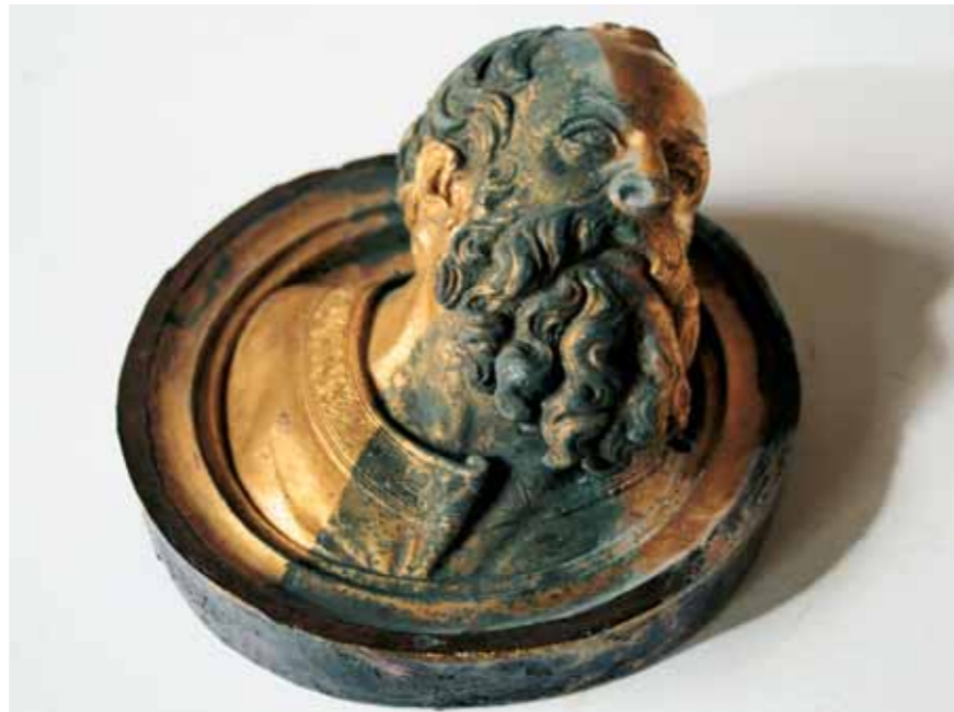
Radiografie (oben) eines Bronzekopfes (rechts) vom Paradiestor des Baptisteriums (Seite 49) in Florenz. Der linke Teil des Kopfes wurde mit einer Lasertechnik gereinigt, der rechte mit einer chemischen Methode, die Mitte ist noch ungereinigt. Oben links ist in der Radiografie das aufgefüllte Loch sichtbar.
