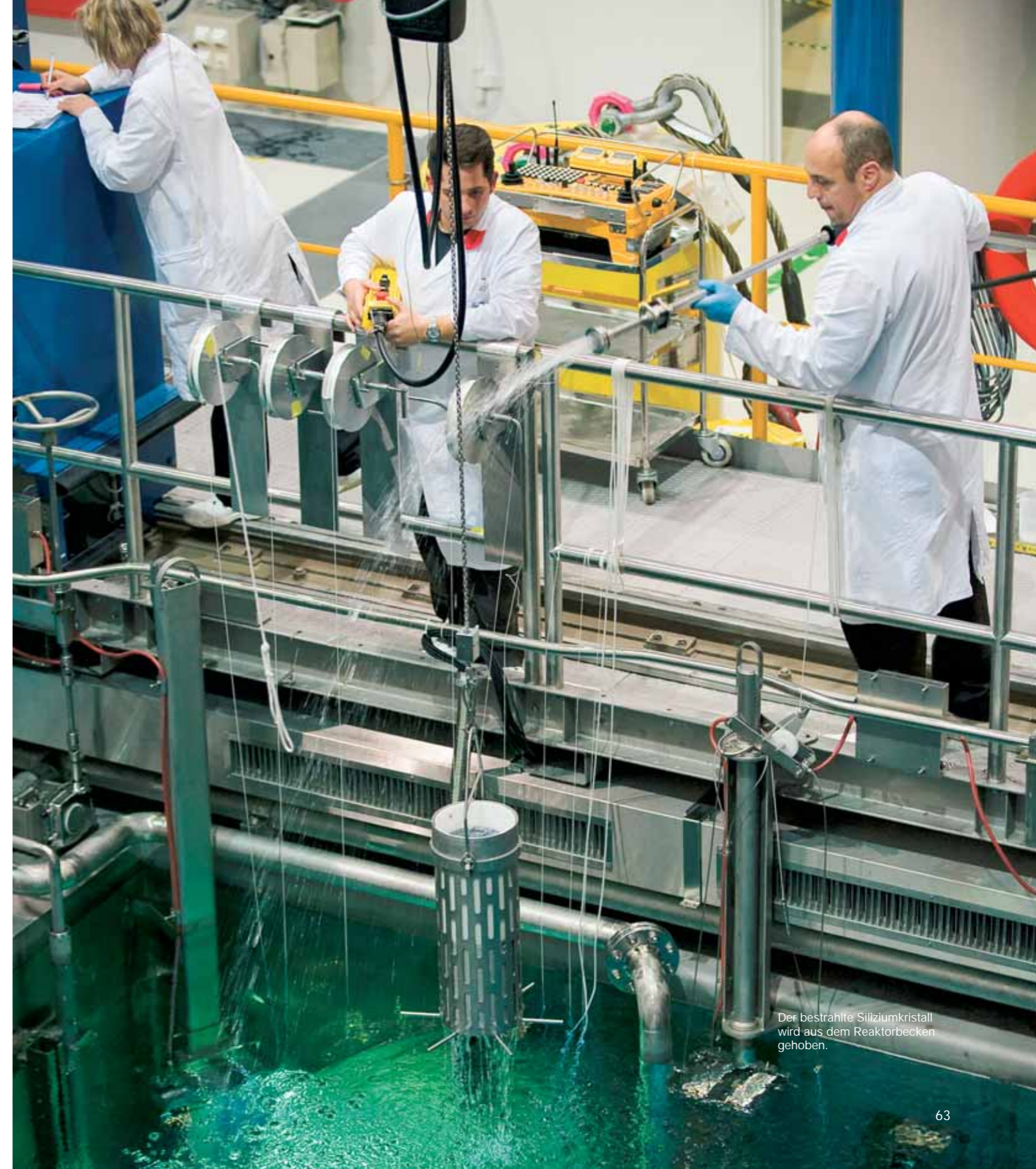
Das fertige Produkt: Siliziumblock nach der Dotierung durch Neutronen.
