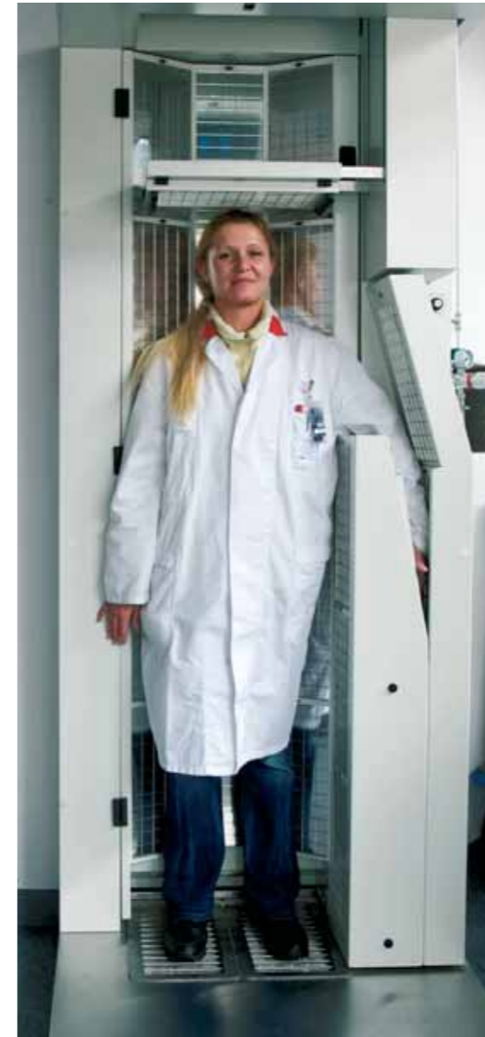
Im Ganzkörpermonitor werden beim Verlassen der Kontrollbereiche alle Personen überprüft.
