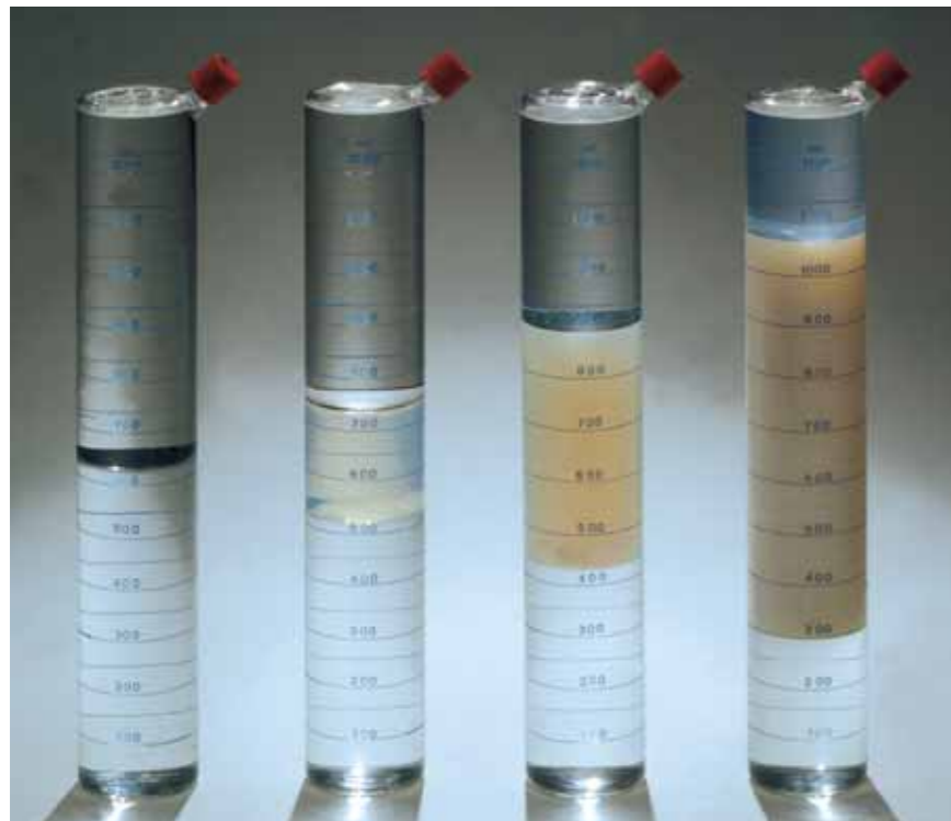
Durch Zugabe eines bestimmten Polymers erhöht sich die Löslichkeit von Öl in Wasser. Von links nach rechts: Öl und Wasser, Öl und Wasser mit Tensid, Öl und Wasser mit Tensid und 0,2 Prozent Polymer sowie Öl und Wasser mit Tensid und 0,5 Prozent Polymer.
