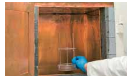
6. Messung der Gammastrahlung, die von der radioaktiven Probe ausgeht.
