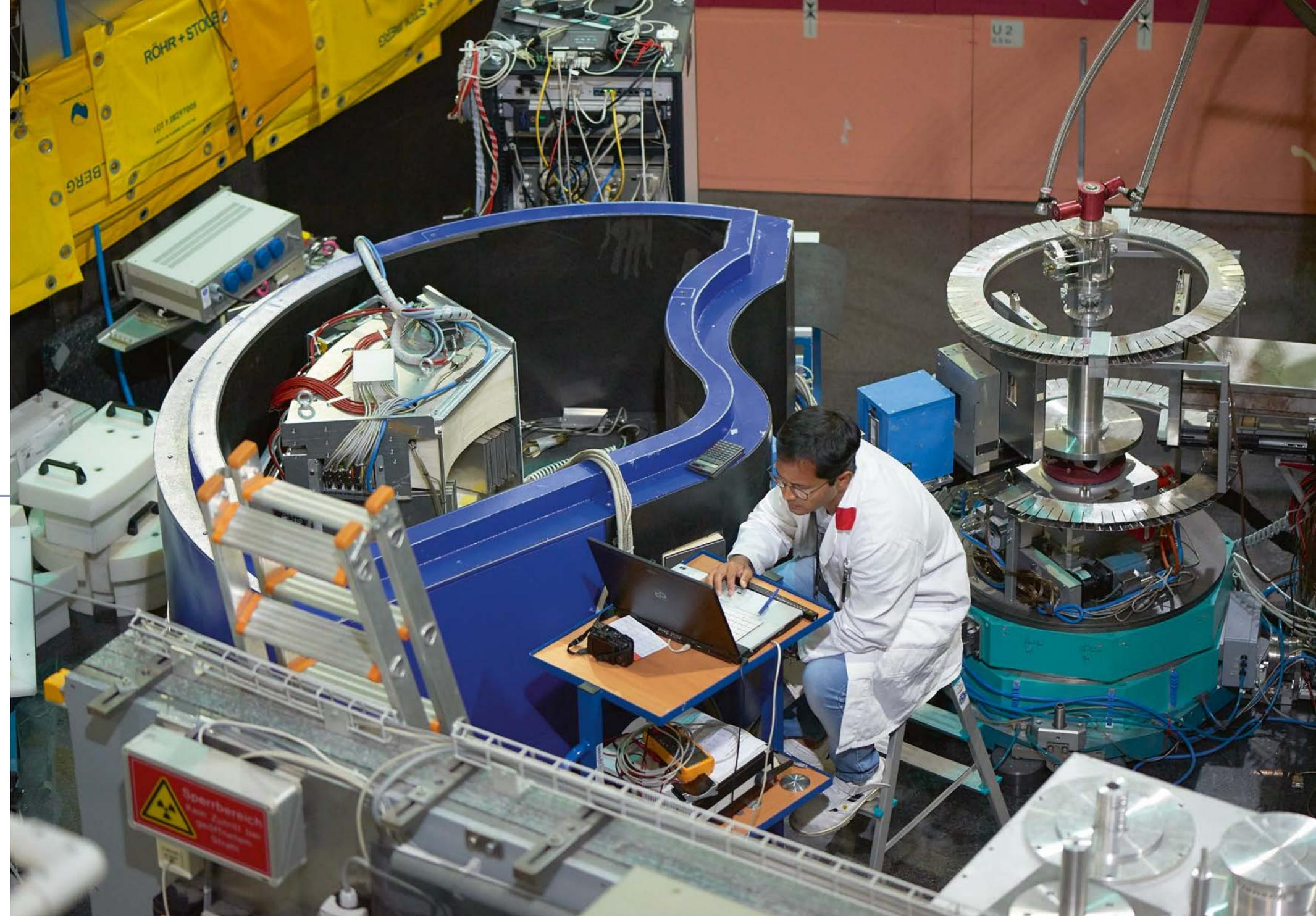
**D**ie Zeit ohne Neutronen nutzen die Instrumentwissenschaftler:innen, um ihre wissenschaftlichen Geräte umzubauen oder zu verbessern. Hier baut Dr. Avishek Maity das Multi-Analysatorsystem am Instrument PUMA (Dreiachsenspektrometer mit Polarisationsanalyse und Multi-Analysator) ein.
